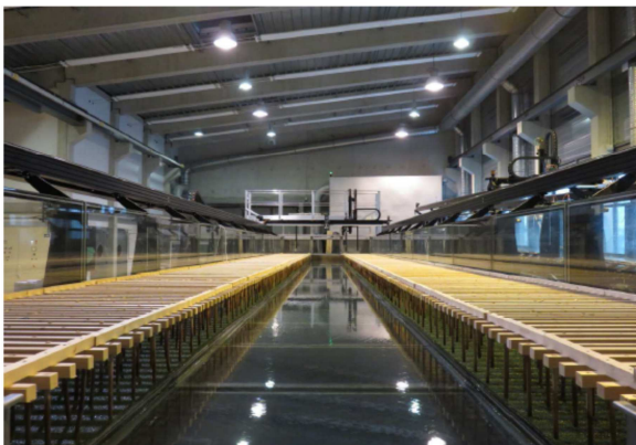
Figure 1 – Canal large 18m x 3m, Irstea lyon. Expériences de Dupuis [2016] et [Dupuis et al., 2016a]. Modélisation des arbres en lit majeur : (à gauche) distribution uniforme d'arbres ; (à droite) transition arbres / prairie.
