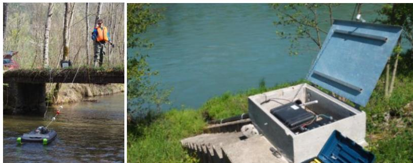
**Figure 3 : a) Hydrophone mobile sur radeau (mesure locale) et b) Hydrophone fixe en berge (mesure intégrée)**
