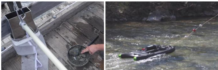
Figure 2 : a) Le préleveur Elwha b) l'hydrophone monté sur un radeau
