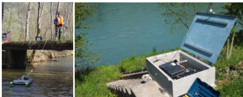
Figure 3 : a) Hydrophone mobile sur radeau (mesure locale) et b) Hydrophone fixe en berge (mesure intégrée)
